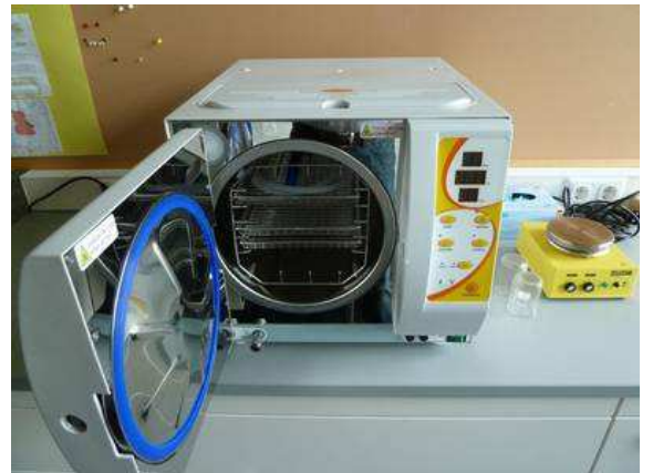
Damit anschauliche Unterrichtsversuche mit Zellkulturen weiter durchgeführt werden können, wurde für die Fachschaft Biologie ein Autoklav angeschafft. Nach Gebrauch werden die verwendeten Zellkulturen darin vorschriftsmäßig vernichtet.
